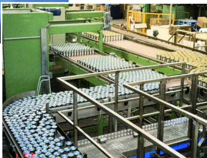
Einzelabfüllung von Convenience-Tierfutter (Tetra Recart) in Hochgeschwindigkeit.
