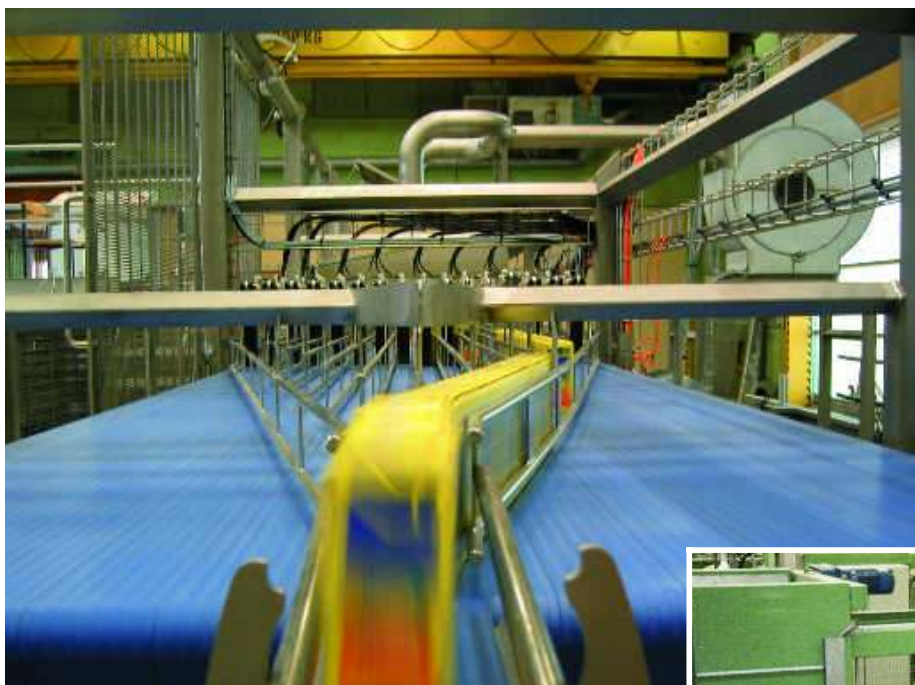
Einzelabfüllung von Convenience-Tierfutter (Tetra Recart) in Hochgeschwindigkeit.
