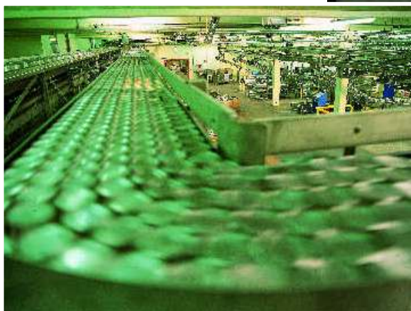
Hochgeschwindigkeitentladen von Aluschalen mit Katzenfutter mittels Vakuumbechern.
