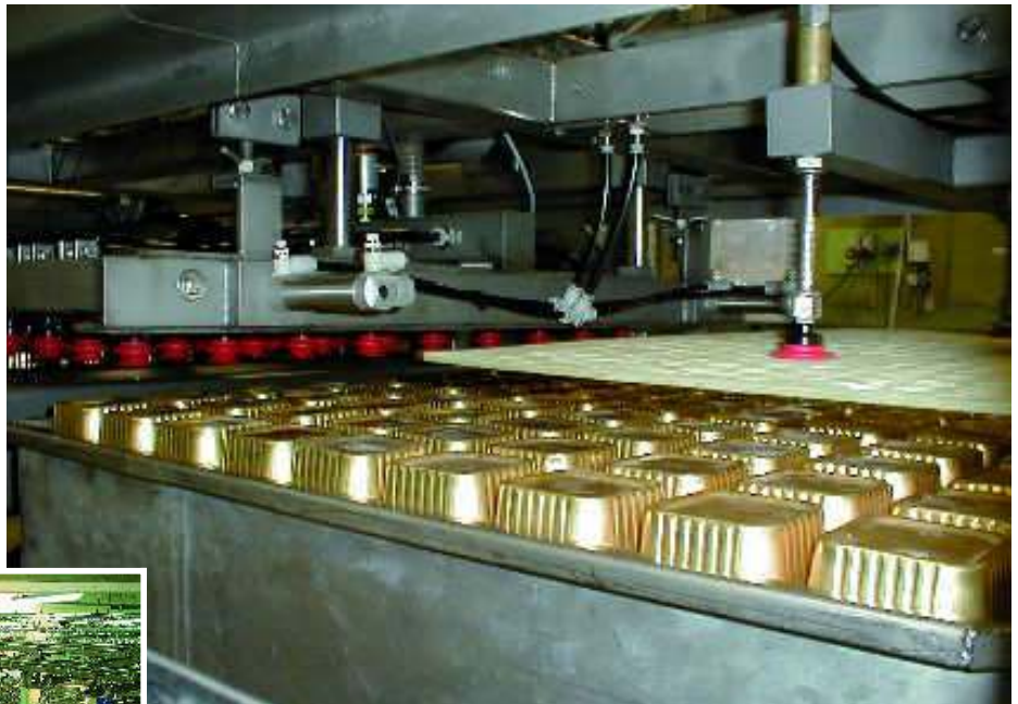
Hochgeschwindigkeitentladen von Aluschalen mit Katzenfutter mittels Vakuumbechern.
