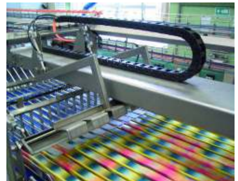
Beladestation, in der Racks mit befüllten, autoklavierbaren Kartonverpackungen bestückt werden – vor der Sterilisation.
