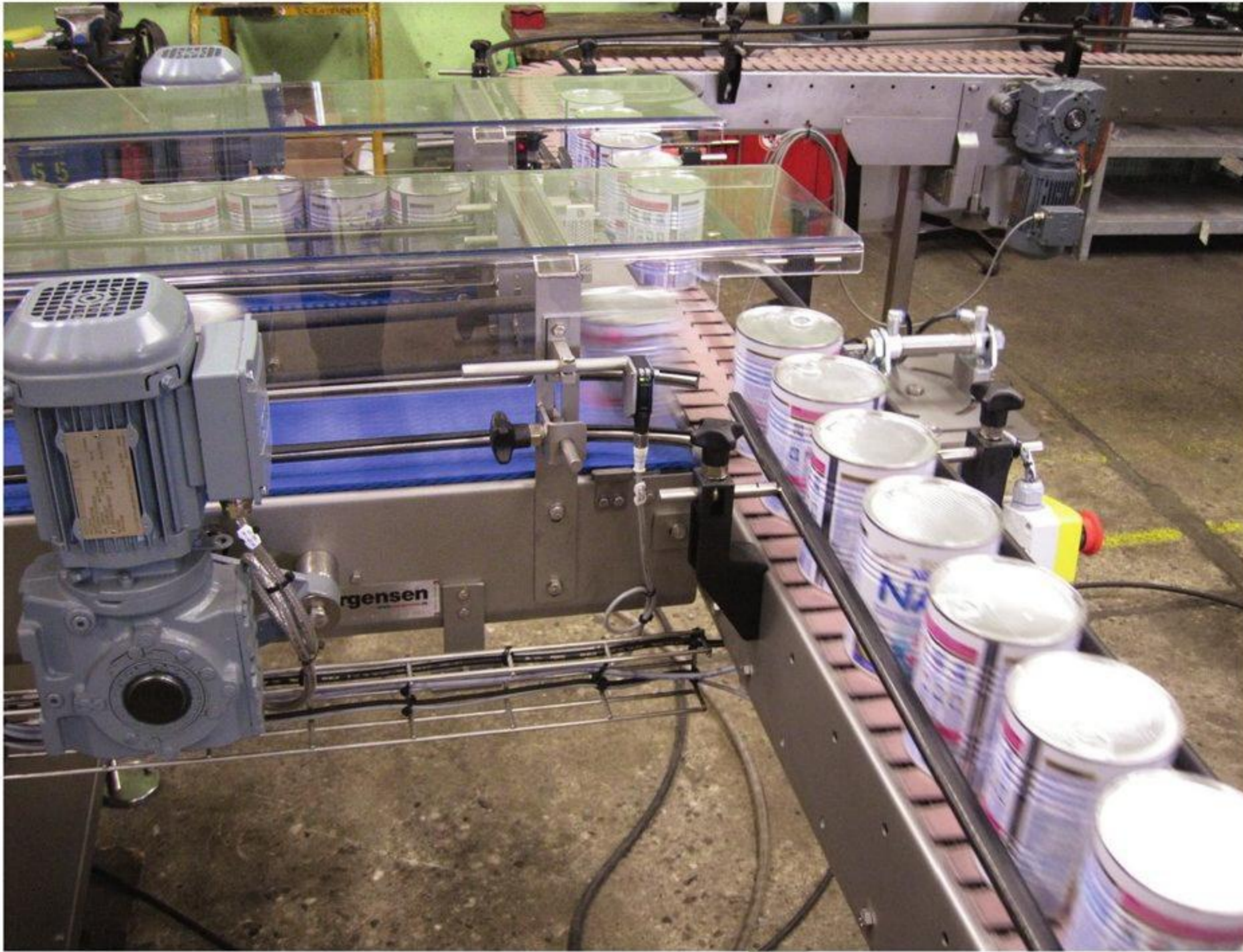
Leaktesteren er en stikprøvekontrol. Produktionshastigheden er oppe på 400 dåser pr. minut
