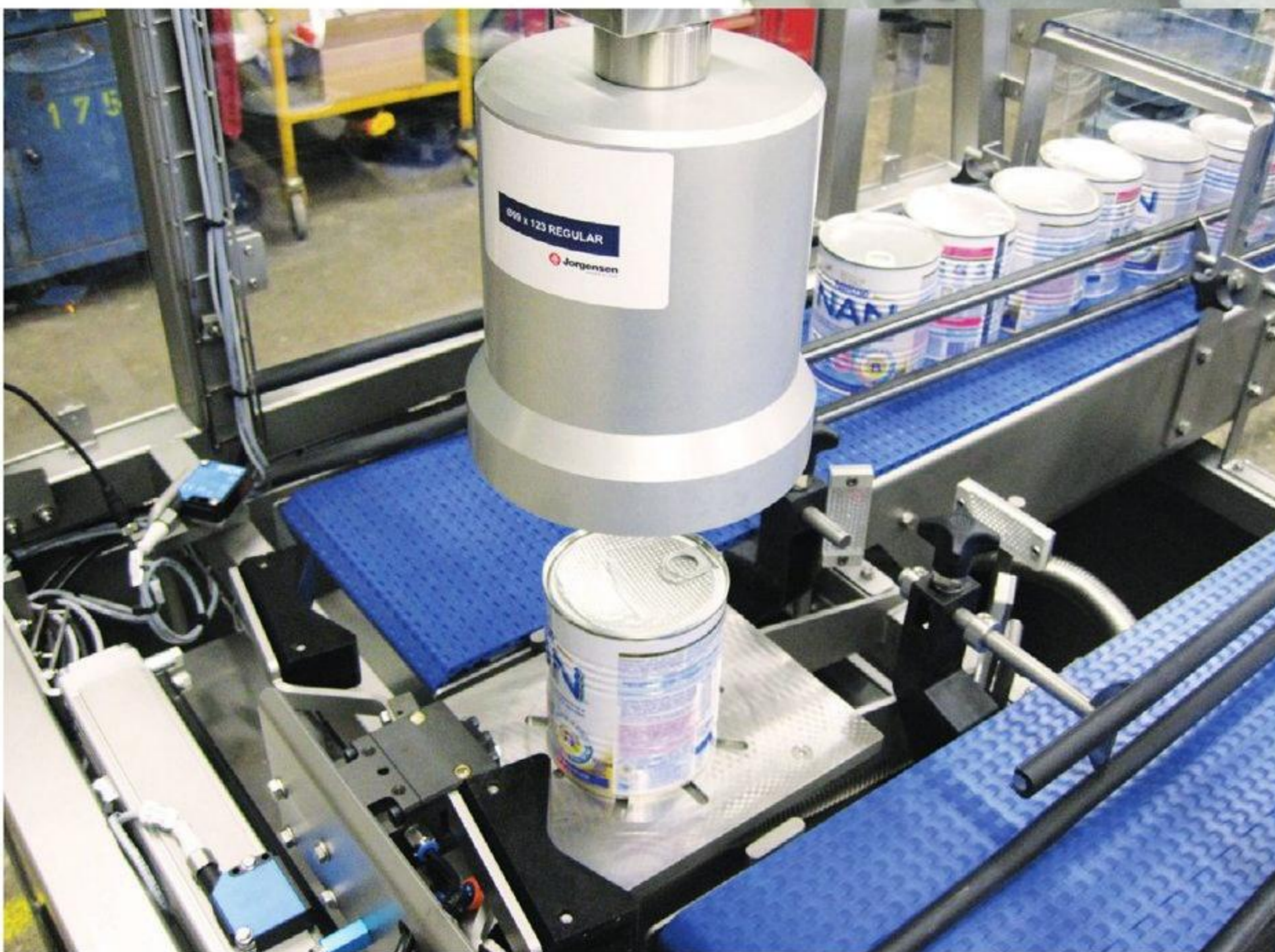
Testen for lækager er en ikke-destruktiv test, der er skånsom over de enkelte dåser
