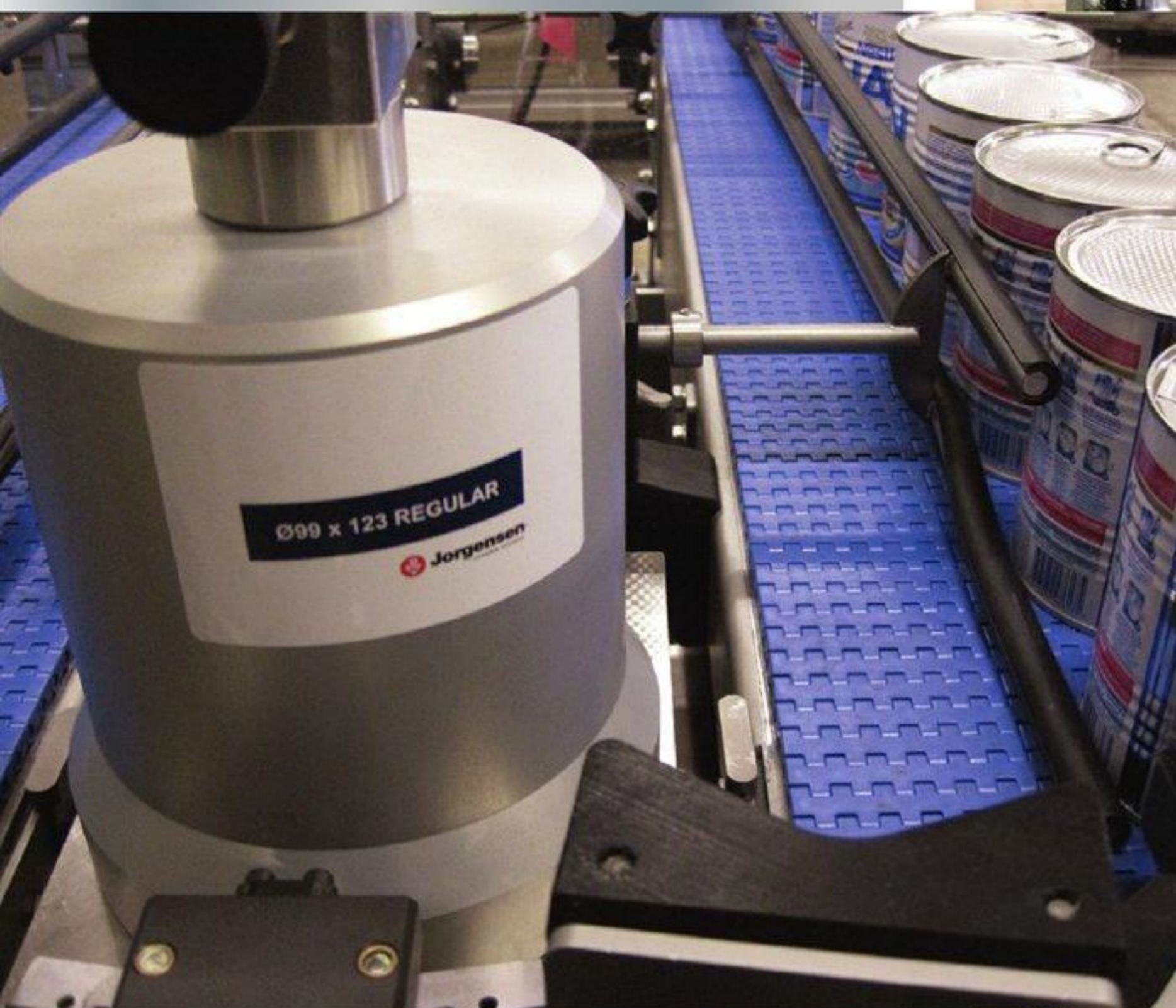
Helium bruges som sporstof til at finde utætheder i dåser med mælkepulver.
